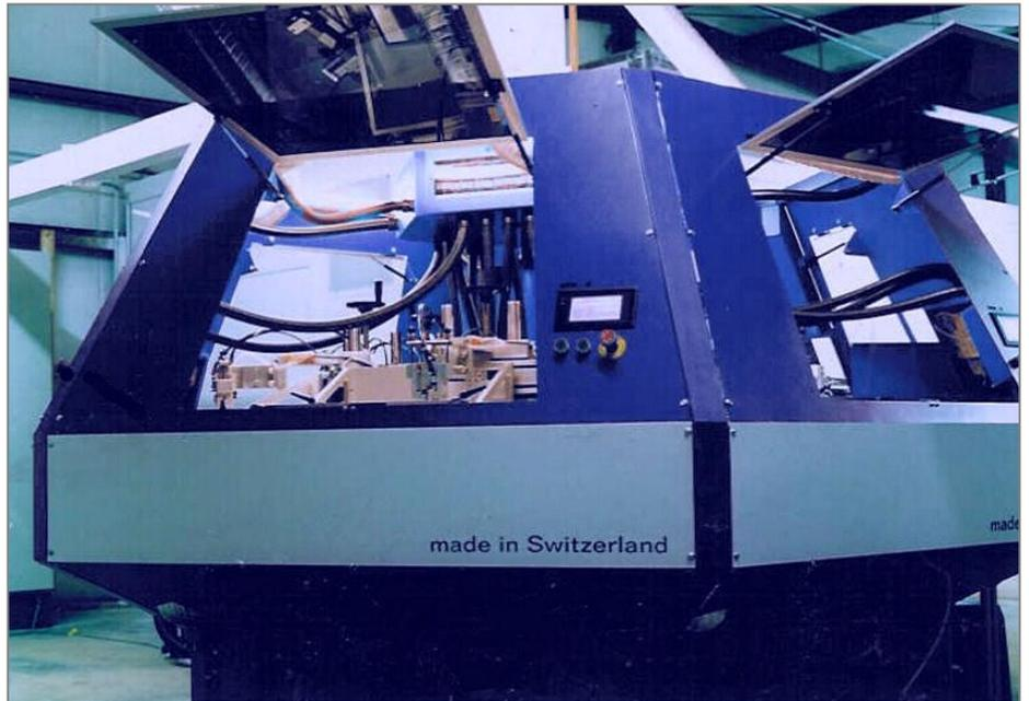
Dadurch entstand für den Endkunden die Möglichkeit, auch nachträglich weitere Bearbeitungsstationen zu kaufen und selber anschliessen zu können. Kosteneinsparung dank Plug and Play im Grossformat. Bei der Entwicklung der Software konnten viele bereits bestehende und getestete Softwaremodule verwendet werden. Zum Beispiel die Ansteuerung der Servomotoren oder das Bedienkonzept der Panels mussten bei der Entwicklung nur noch ins Programm eingebunden und konfiguriert werden.
