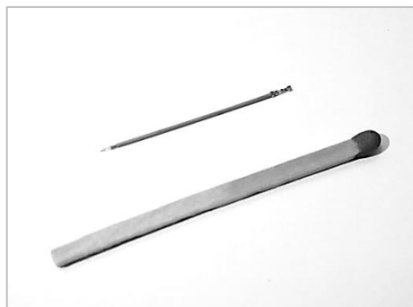
Mikrokoaxialkabel mit Crimpstecker im Grössenvergleich. Der Innenleiter ist so dünn wie ein Haar.
